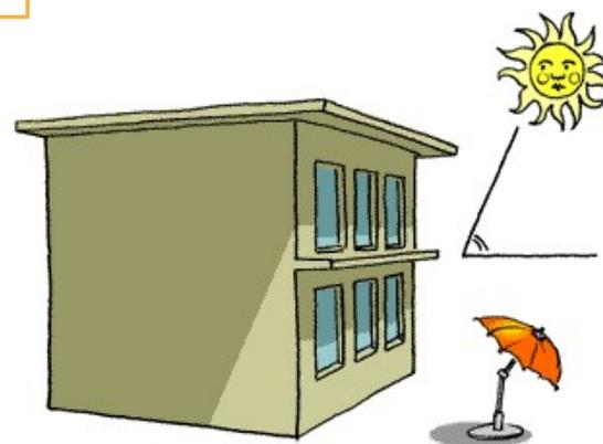
En été à midi, le soleil est haut sur l'horizon: un avant-toit bien conçu permet de mettre à l'ombre les fenêtres du bâtiment pour éviter la surchauffe.
